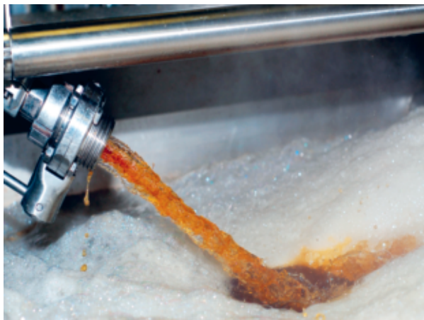
ブリュッセルにあるドリーフォンテイネンで、 クールシップに沸騰した麦汁を加えるところ
